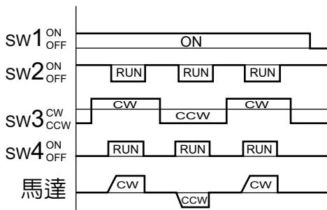
**(9) 正逆轉+強制風扇+電磁剎車+變速**
