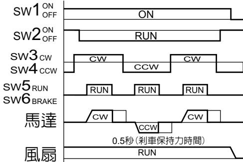
**(8) 正逆轉+電磁剎車+變速**
